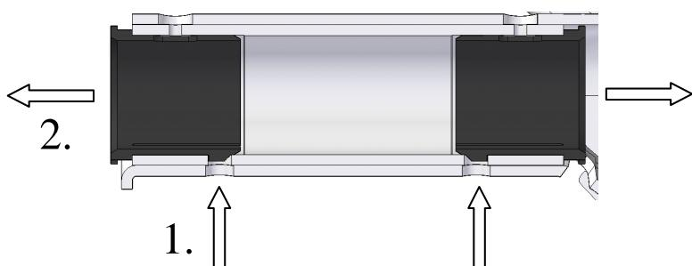
Den Schnapperverschluss vorsichtig nach oben drücken und das Führungslager aus dem Gehäuse ziehen.
