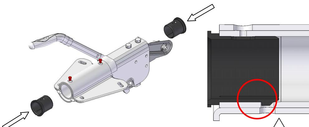
Die neuen Führungslager einsetzen und darauf achten, dass die „Nasen“ vollständig einrasten. Gegebenenfalls Buchse leicht im Gehäuse drehen.
